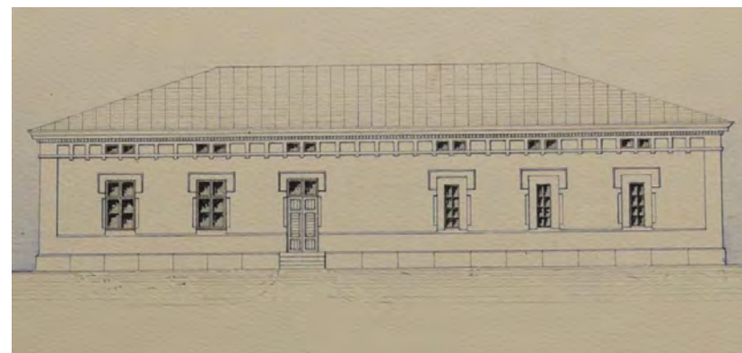
Kuva: Varuskunnan vanhimman leipomorakennuksen julkisivujen tiilikoristelussa on samoja aiheita kuin sotilaskasarmeissa. Räystään alla on lokerofriisi ja ikkunoiden yläosassa on U-volyyminen kehys. Keskistä seinäalaa rajaa koholla oleva seinäpinta ikkunan ja sokkelin välissä sekä nurkkaliseenit. / Julkisivupiirustus, PHRAKL:n arkisto.
